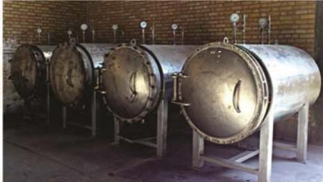
ساخت اتوکلاوهای صنعتی تا فشار ۱۵ اتمسفر
