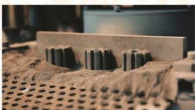
ساخت تجهیزات شکل دهنده قطعات سرامیکی
